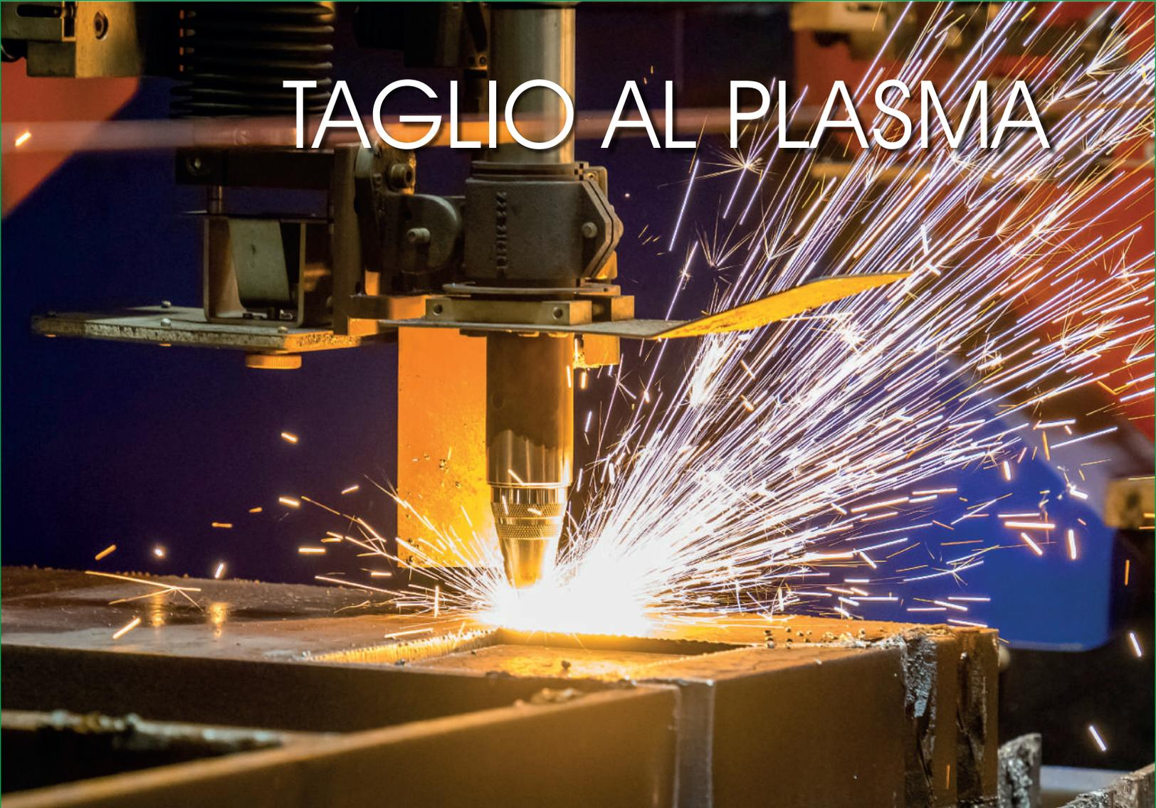
Questa tecnica utilizza un getto ionizzato ad alta temperatura per tagliare con precisione e velocità materiali conduttivi come l'acciaio inossidabile, l'alluminio e l'acciaio al carbonio.
